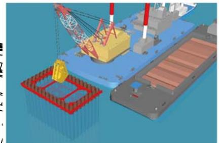
「井筒」内の海底を掘り下げます。掘り出した土砂は所定場所に適切に処理します。
