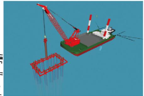
「鋼管矢板」を海底地盤に打ち込みます。鋼管矢板は橋脚1基当たり38本を使用し、長方形に配置します。これを井筒と言い橋脚を支える基礎となります。
