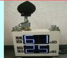
海上での『鋼管矢板』の打ち込みに際しては、生活環境に配慮するため、陸上工事の場合に課せられる騒音・振動規制に準拠した作業を実施します。
